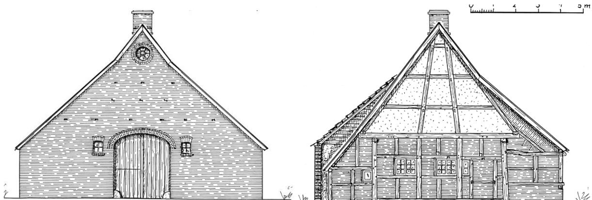
Abbildung 66: Vorder- (links) und Rückgiebel (rechts) des Heuerhauses der ehemaligen Hofstelle Splanemann in Gersten (Dr. Maschmeyer)
